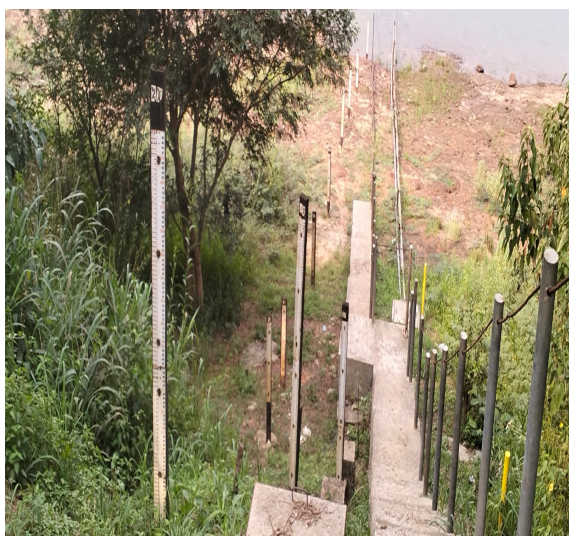
Figura 5.5: Reglas hidrométricas, Cdad. del Este.
