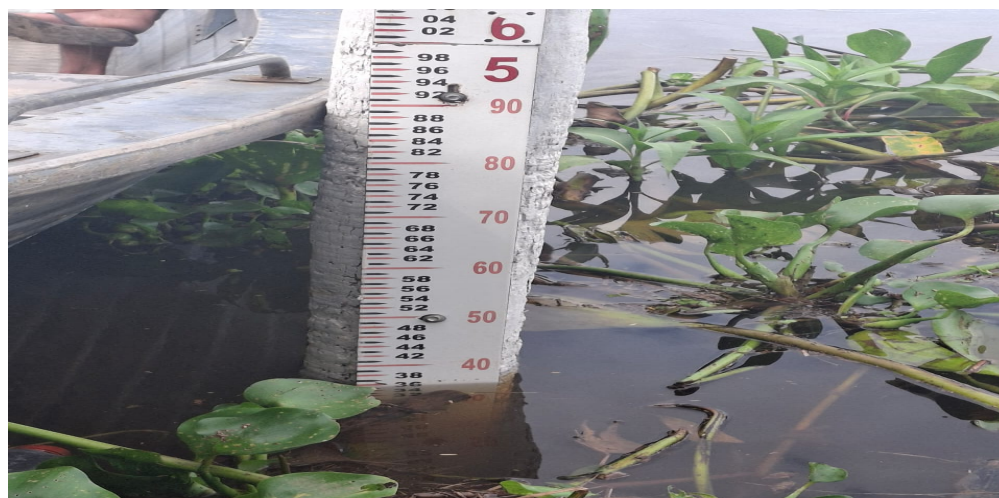
Figura 5.3: Regla hidrométrica en Isla Margarita.
