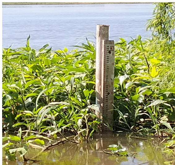
Figura 5.2: Regla hidrométrica en Alberdi.
