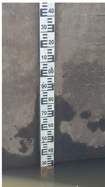
Figura 2.1: Regla hidrométrica, Villa Florida. Fuente: Gcia. de Observaciones Hidrológicas - DMH.
